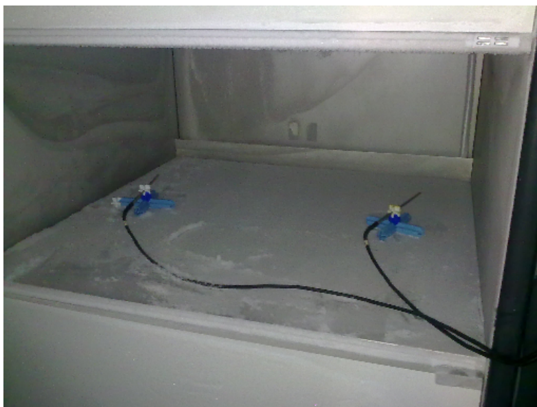
Obr. 7 Ilustrační foto umístění sond (JOUAN VX430)
