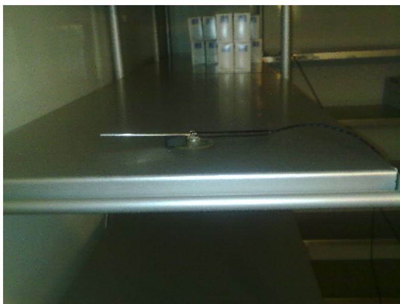
Obr. 4 Přichycení sondy do police regálu
